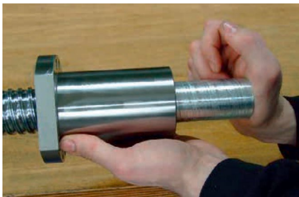
Rys. 4.6: Nakręcenie nakrętki ze zgarniaczem na śrubę
