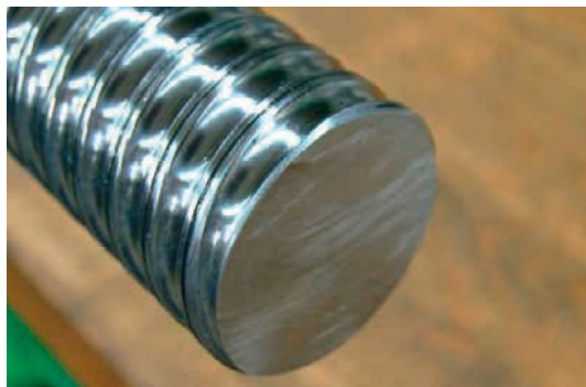
Rys. 4.3: Zakończenie śruby przed montażem zgarniacza NBR
