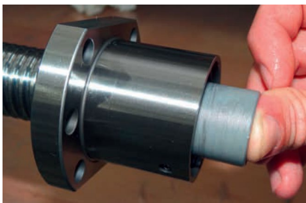
Rys. 4.11: Demontaż nakrętki przy użyciu tulei montażowej
