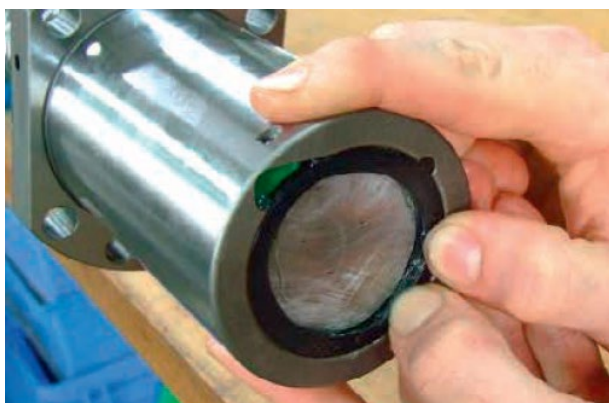
Rys. 4.7: Przytrzymanie zgarniacza podczas powolnego nakręcania nakrętki na śrubę
