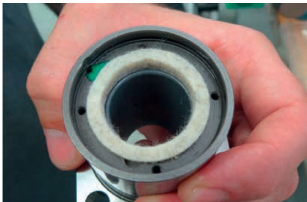
Rys. 4.13: Nakrętka z włożonym zgarniaczem filcowym
