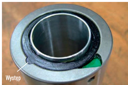
Rys. 4.4: Kontrola prawidłowego osadzenia zgarniaczy przed montażem
